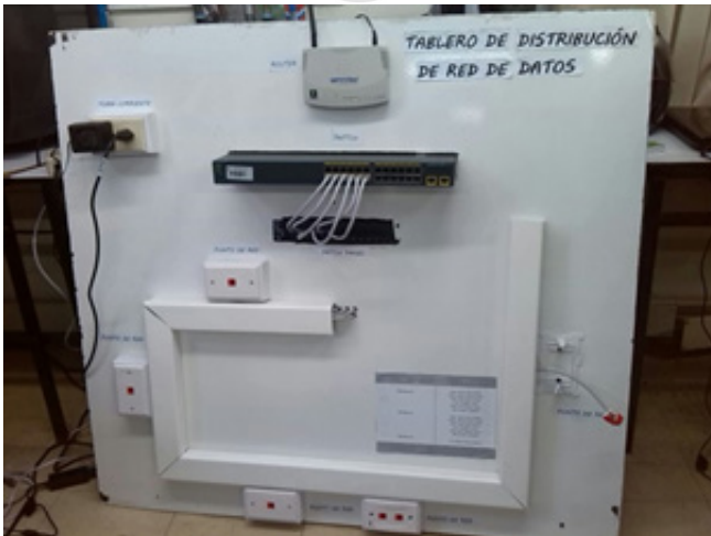
Imagen 1 Tablero Implementado para la Infraestructura tecnológica (Autores, 2015)
