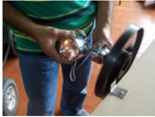
Figura 11. Dínamo Generador diseñado (Fuente: Autores)
